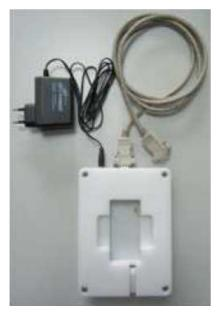
Перед тем как начнется обмен данными между компьютером и распределителем, интерфейс должен быть активирован коротким нажатием кнопки, после чего он остается активным около 15 секунд. Более подробную информацию вы можете найти в техническом описании программного обеспечения по вводу параметров.
