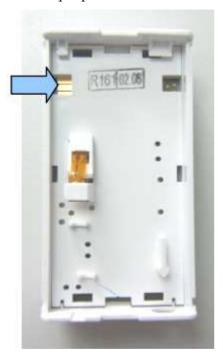
Внимание! Контактный интерфейс может быть использован только тогда, когда распределитель не установлен на тепловом адаптере. В комплекте с адаптером поставляются блок питания и соединительный кабель для USB-интерфейса компьютера.
