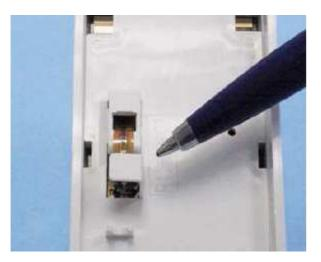
На задней части распределителя крышка датчика должна быть удалена. Для этого отгибают крышку датчика в сторону и удаляют ее.
