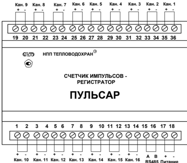
Рис. 7.1 Схема клеммников счетчика
