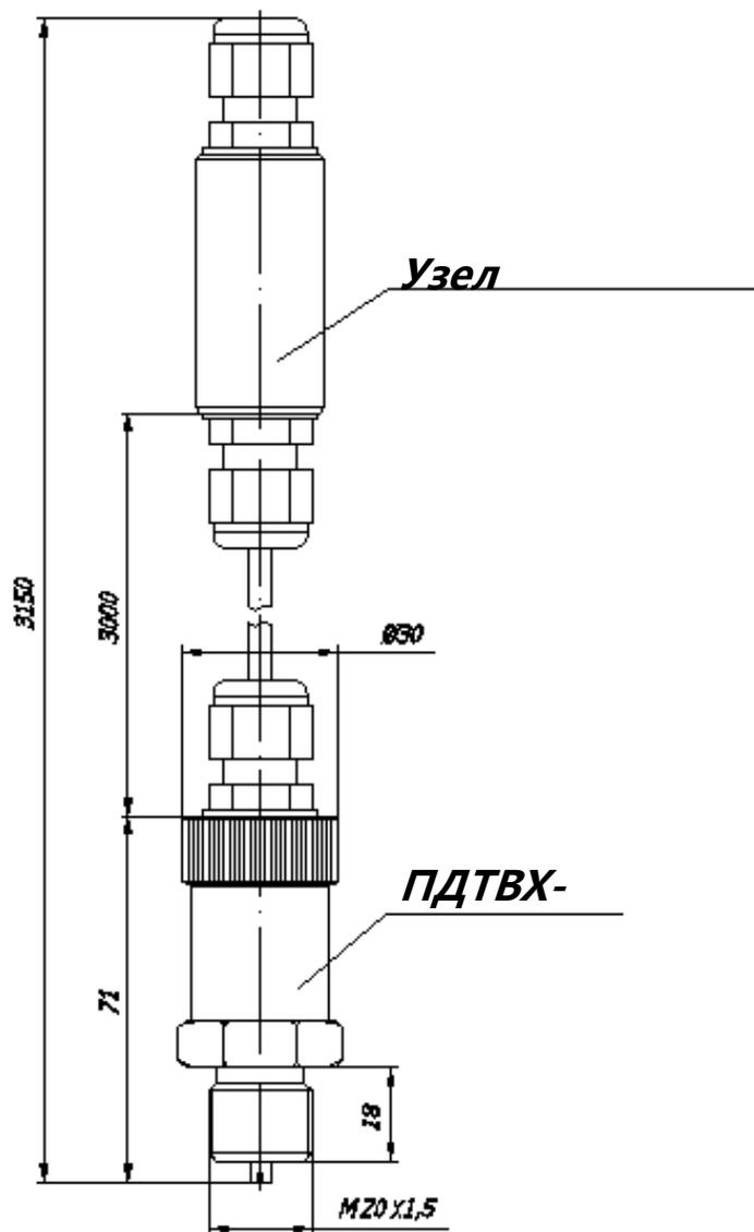
Рис. 1 Преобразователь избыточного давления ПДТВХ-1-04
