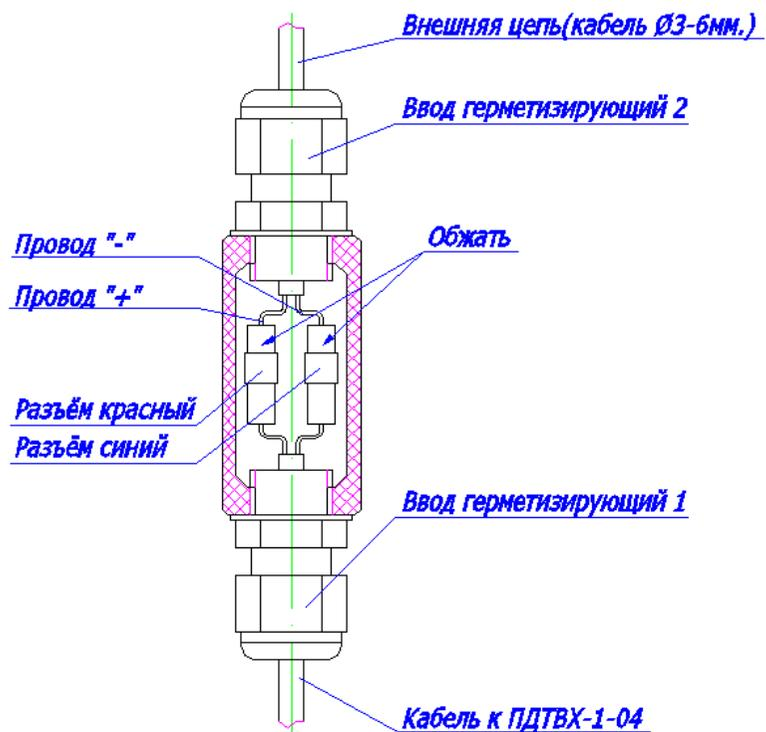
Рис. 2 Узел соединительный
