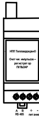
Рис. 7.1 Схема клемников базового модуля
