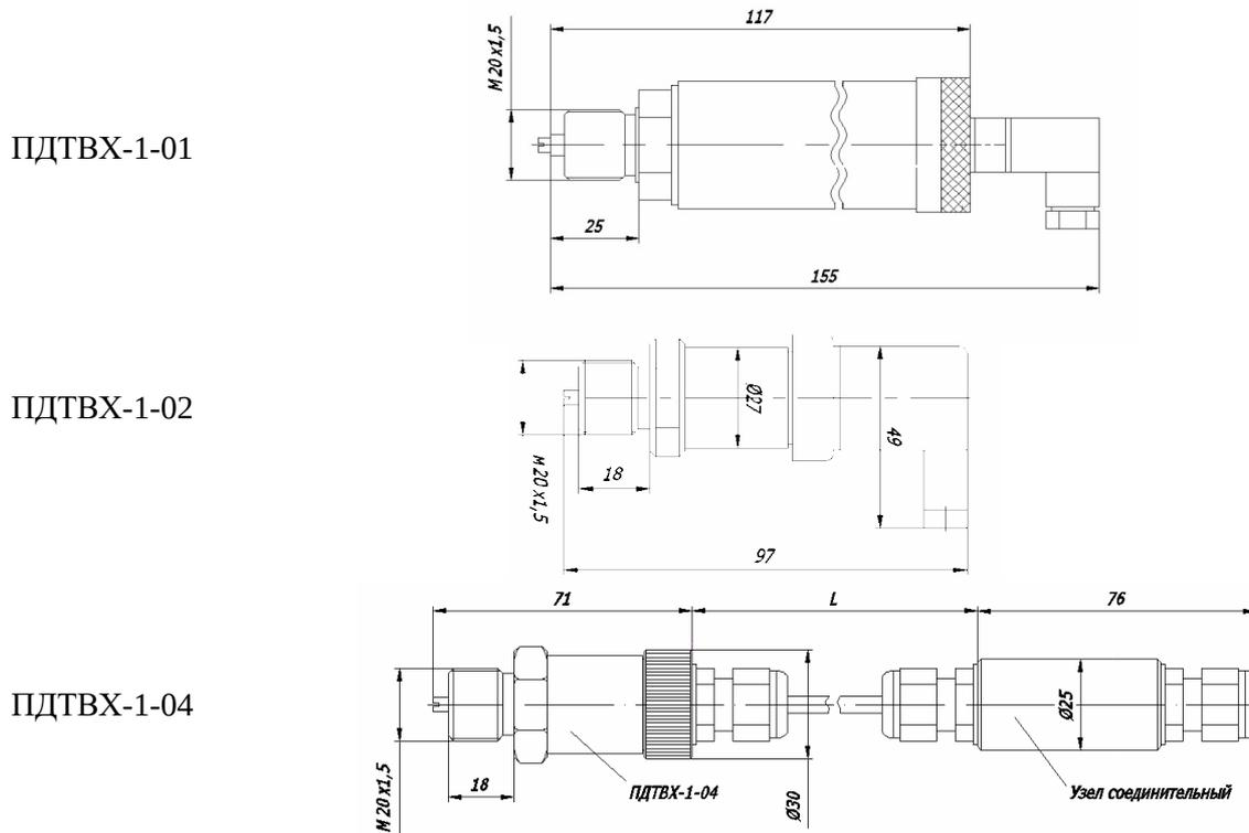
Длина кабеля L = 1...100 м – определяется при заказе (шаг 1 м)
